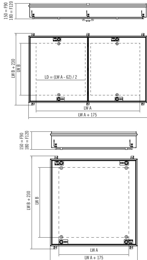
**Couvercles pour chambres de tirage et conduits d'alimentation dans les tunnels, modèle carré**
